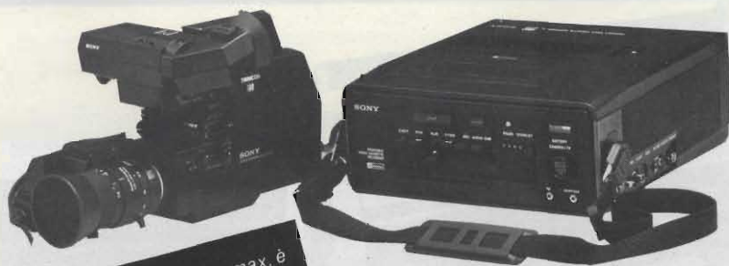
Fig. 14 - Sony SL 3000: portatile Betamax, è stato il primo disponibile in Italia ed è anche uno dei migliori per qualità. Oltre le normali funzioni consente il doppiaggio dell'audio. Tre le possibilità di alimentazione (rete, batterie, accumulatore).
