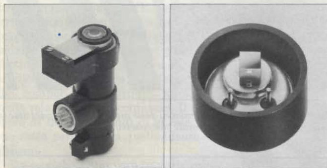
Fig. 4 - La lettura delle piste è ottica e non meccanica: la "puntina" è infatti costituita da un raggio laser focalizzato sul centro delle piste. A sinistra: unità completa di lettura a laser. A destra: laser a semiconduttore.
