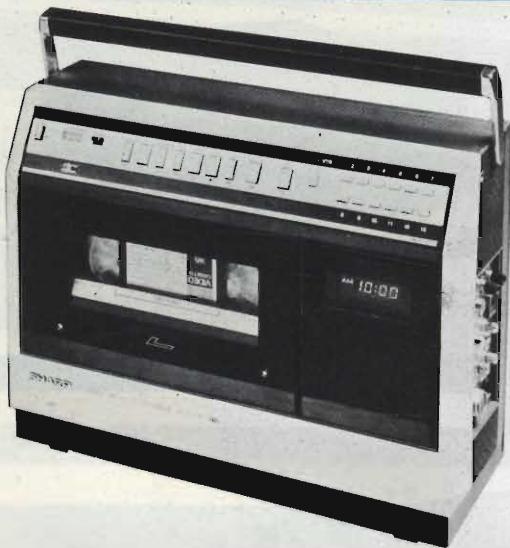
Fig. 18 - Sharp VC 2250: assai innovativo questo VHS che dalla forma ricorda un grosso radiore portatile. Nel 2250 diventa portatile anche la sezione tuner cosicché tutto l'apparecchio è indipendente dalla presa rete. La tastiera è logica e con la sezione tuner-timer è possibile sintonizzare 12 stazioni e programmare 1 intervento per 10 giorni.
