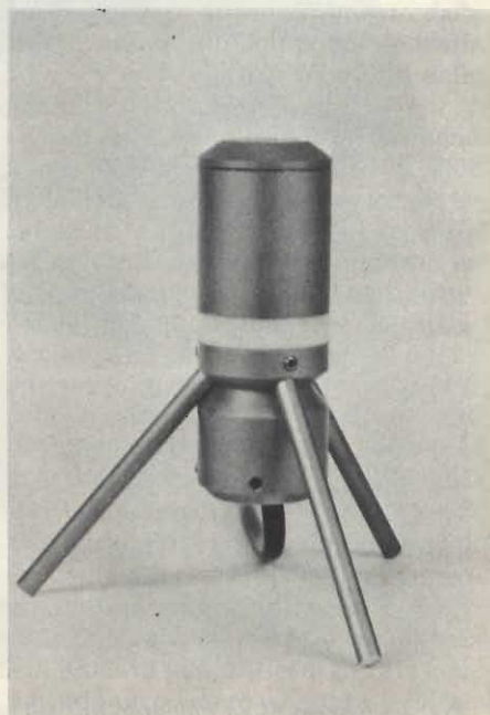
Fig. 1 - Modernissime antenne di piccole dimensioni per la ricezione delle emissioni provenienti da satelliti artificiali, destra tipo TRANSIT, per frequenze VHF, a sinistra a parabola con relativo convertitore.
