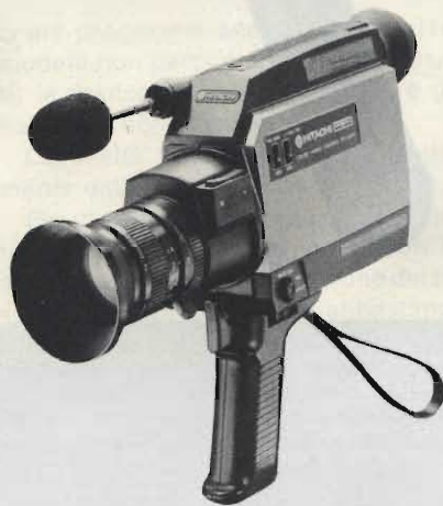
Fig. 22 - Hitachi VK C 800 E: è la prima telecamera che utilizza un tubo Saticon, di derivazione professionale. Dispone di zoom con motore e di dispositivo autofocusizzante. Il diagramma è automatico e consente effetti di dissolvenza e l'esposizione automatica. Il prezzo è di 2.100.000 lire.
