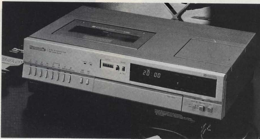
Fig. 1 - Panasonic NV 7000: si tratta di un VHS domestico con tastiera elettronica, possibilità di ricerca veloce e fermo immagine. Adotta il Dolby e dispone di preselezione di 12 programmi e di timer per la pre-programmazione della macchina (8 registrazioni in 14 giorni). È possibile il telecomando a filo: il prezzo è di circa 1.550.000 lire.
