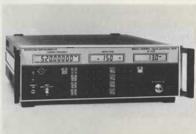
Generatori di segnali AM/FM 2018/2019 della Marconi.
