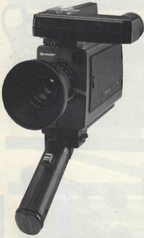
Fig. 25 - Sharp XC 33G: telecamera con tubo Vidicon e mirino ottico. Adotta uno zoom manuale ed è possibile la regolazione della temperatura colore. L'esposizione è automatica. Il prezzo è di 1.340.000 lire.
